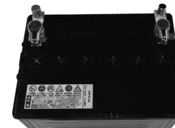
4 変換バッテリーターミナルに車両のバッテリーケーブルを接続して完了です。
