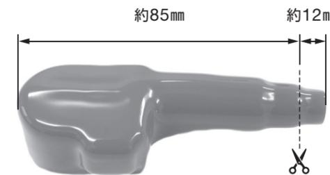
DCPL38-1およびDCPL38-2の適用電線は38mmとなりますが、現状の電線挿入口形状では電線自体を挿入することが出来ません。(※切断作業前の電線挿入口形状は、電線22mm用に設計をされております。)
