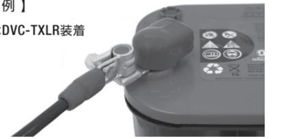
1 車両のバッテリーの端子 (ポール) の太さを確認して、使用する変換バッテリーターミナルを右記から選択します。
