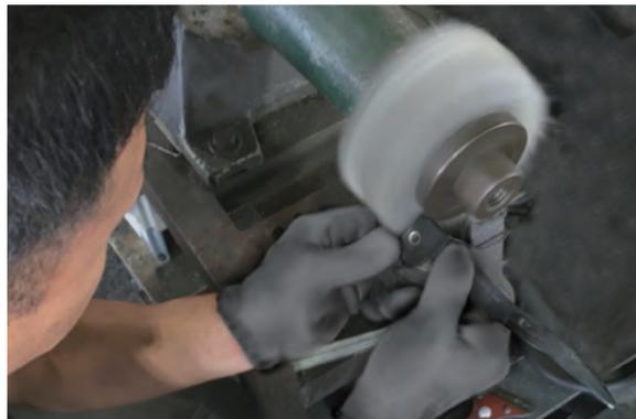
磨き上げ作業が完了後に表面処理を実施します。
