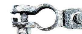
白く見えるのは塩水噴霧による塩で錆は発生していない。
