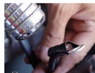
(1) 圧着が完了したらヒートガンを使用して熱収縮チューブを収縮させ、圧着部を保護します。
