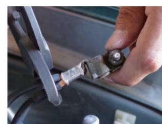
(1) 古い(傷んだ)ターミナルの圧着部付近で電線をカットします。
