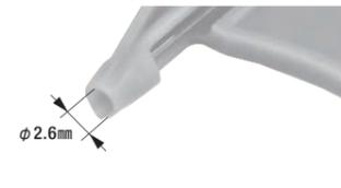
●適用チューブ: ECG-3N・ECG-3C
