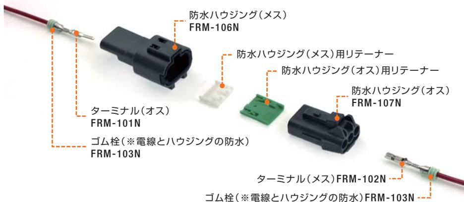
**Point** >>> ハウジング内の防水シールの密着と、ターミナルに圧着したゴム線によって防水機能を発揮します。
